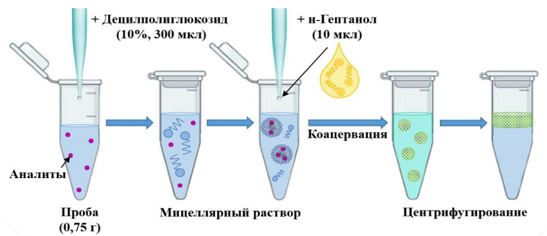
Рисунок 2. Схема микроэкстракции эфиров фталевой кислоты из проб пищевых продуктов в супрамолекулярный растворитель (алкилполиглюкозид в качестве амфифила, первичный спирт в качестве агента коацервации).
